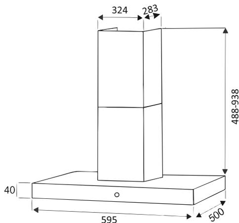
Рис. 1 Внешний вид кухонной вытяжки и схема размеров
