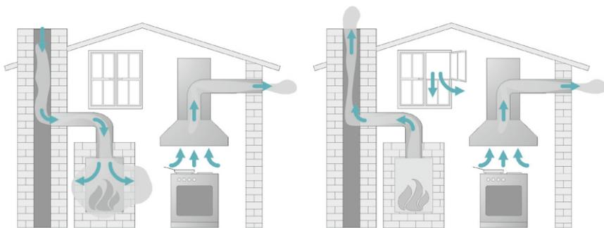
Рис. 3 Одновременная эксплуатация вытяжки и устройства горения
